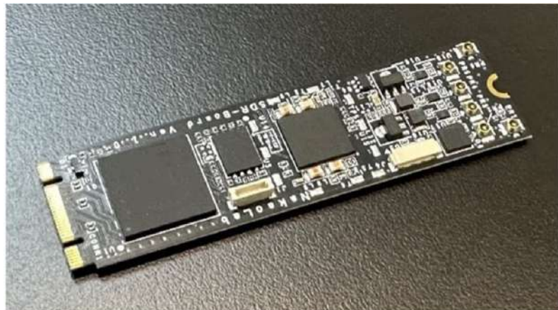
超小型ソフトウェア無線(SDR)ボード ソフトウェア拡張によりプログラマブルな基地局
